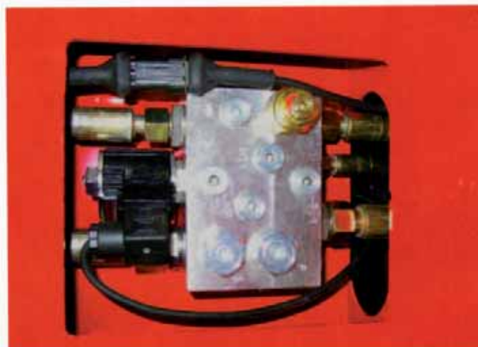
Boîtier hydraulique proportionnel pour la régulation continue de la broche
