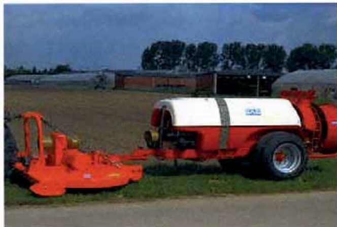
Photo : type SINGLE avec broyeur équipé d'une attache pulvérisateur.
